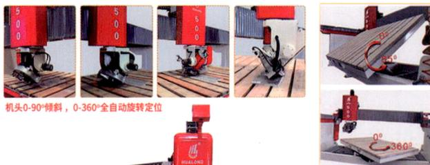
机头0-90°倾斜，0-360°全自动旋转定位
