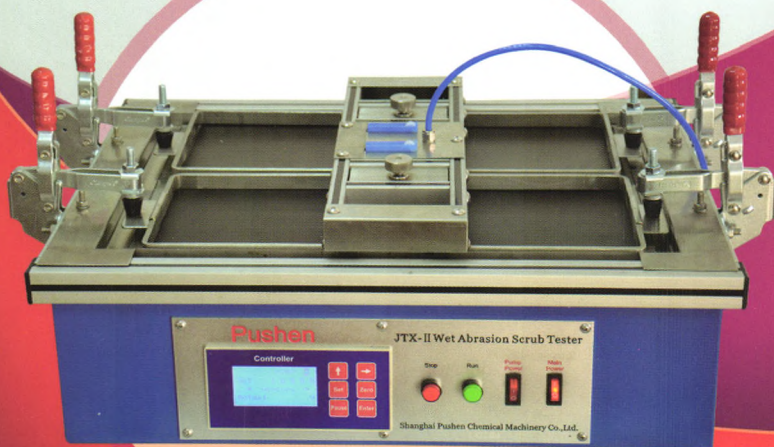
● JTX-II 建筑涂料耐洗刷仪 符合国标GB/T 9755-2014
