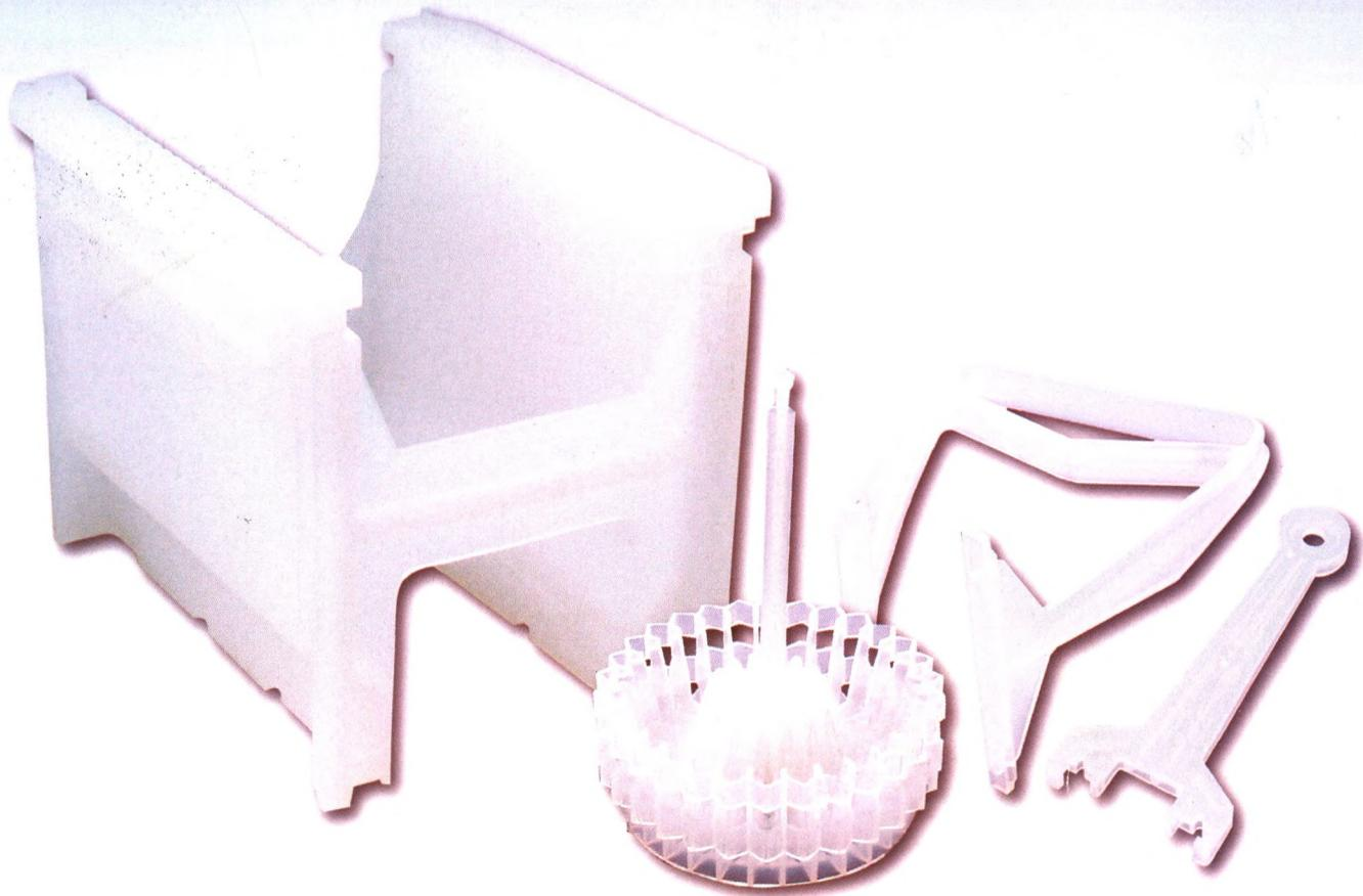
北京市塑料研究所生产的各种硅片承载器，以 PFA 树脂为原料制造而成。具有以下特点：耐强酸，强碱的腐蚀，不被强极性有机溶剂所溶胀，质地柔软，不损伤硅片，不粘污硅片，并与国外同类制品有良好的互换性，可在  $\pm 250^{\circ}\text{C}$  各种介质中长期使用。与承载器相配的还有各种单梁和提把，以及 3 英寸，4 英寸 PP 传递架和传递盒。
