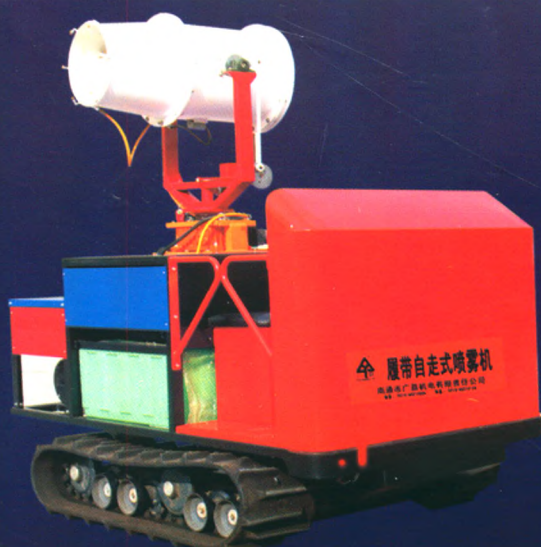
履带自走式高射程喷雾机
