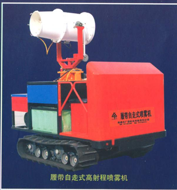
履带自走式高射程喷雾机
