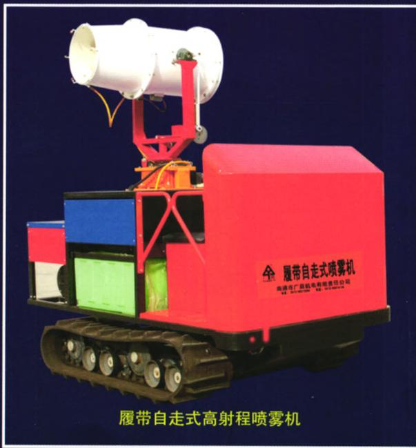
履带自走式高射程喷雾机
