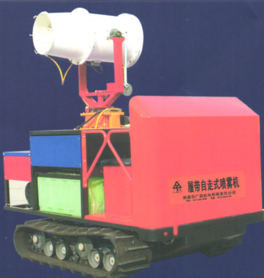
履带自走式高射程喷雾机
