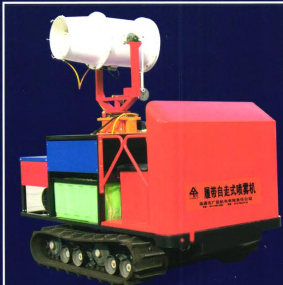
履带自走式高射程喷雾机
