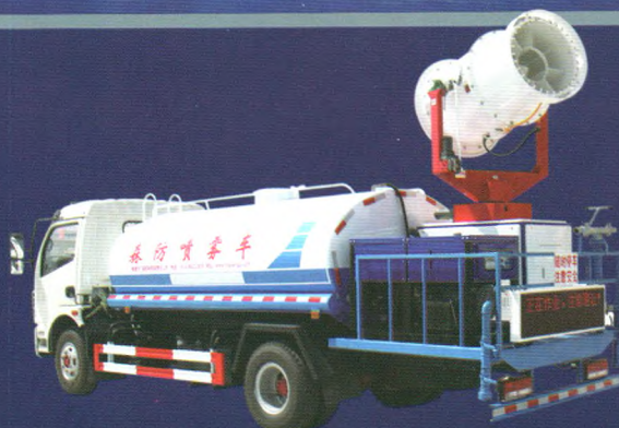
东风多利卡底盘(配套6HW-80C喷雾机组)
