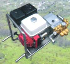
移动式高压远程水泵, 3 800 m 供水,
