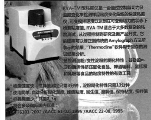
RVA-TM 型粘度仪是一台通过控制剪切力及温度变化来检测样品粘度变化曲线的快速粘度仪，可变速率速度以达到在可变剪切力的状态下检测粘度值。RVA-TM 适合于大多数复杂的粘度测试，从过程控制到研究及产品开发。它的结果可以修正到传统的 Amylograph 方法所表示的结果。“Thermocline”软件用于复杂的测试结果分析。
