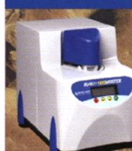
RVA-TM 型粘度仪是一台通过控制剪切力及温度变化来检测样品粘度变化曲线的快速粘度仪，可测搅拌速度以达到在可变剪切力的状态下可测粘度值。RVA-TM 适合于大多数复杂的粘度测试，从过程控制到研究及新产品开发。它的结果可以修正到传统的 Amylograph 方法所表示的结果，“Thermocline”软件用于复杂的测试结果分析。
