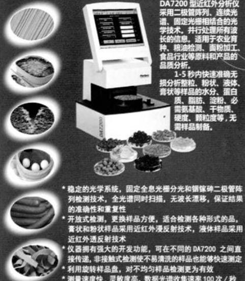
DA7200型近红外分析仪采用二级臂阵列、连续光谱、固定光栅相结合的光学技术,并行处理所有波长的信息,适用于农业育种、粮油检测、面粉加工、食品行业等原料和产品的品质分析。
