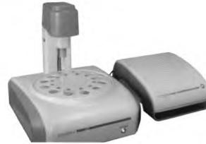
SmarTongue型电子舌：又称味觉分析仪，用于液体或半固体的样品的味觉分析，是由交互敏感传感器阵列、信号采集电路、模式识别等的数据处理方法组成的现代化定性定量分析检测仪器。
