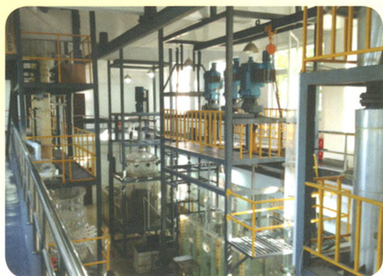
反应器研究大型冷模实验平台
