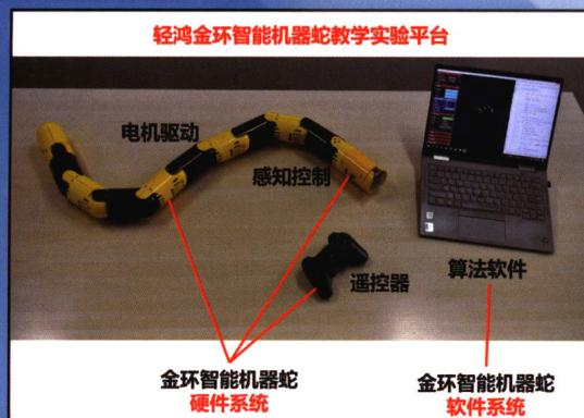
轻鸿金环智能机器蛇教学实验平台包括了智能机器蛇的硬件系统和软件系统。硬件系统包括电机驱动系统头部感知与控制系统遥控器；软件系统包括各种机器人感知驱动和控制算法等。
