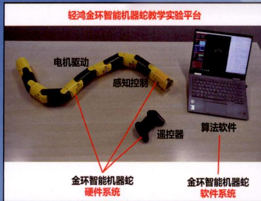
轻鸿金环智能机器蛇教学实验平台包括了智能机器蛇的硬件系统和软件系统。硬件系统包括电机驱动系统头部感知与控制系统遥控器；软件系统包括各种机器人感知驱动和控制算法等。
