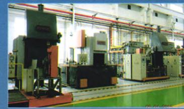
拥有国际先进的底装料电加热立式多用炉、可控气氛多用炉，年热处理能力45000吨，配备先进的质量检测、金相分析仪器及辅助设备。
