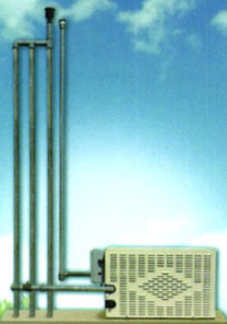
油气封存冷凝系统
