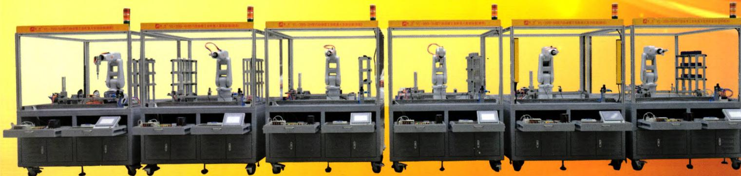
亚龙YL-399H型六自由度工业机器人实训设备系列产品包含搬运、装配、堆垛、物流、涂胶和自动锁螺丝等多种功能。该系列产品是在一个标准产品的基础上进行扩展，使教学模块化、标准化，同时又可以开发学生的创新思维；学生还可以进行设备的二次开发，真正实现学生在做中学，学中做的乐趣，提高了设备的使用效率。
