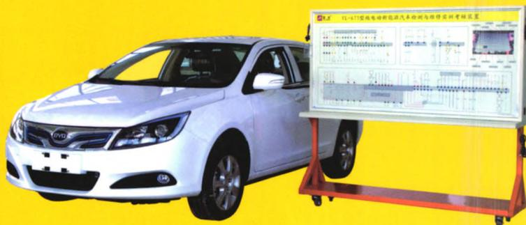
本设备是由汽车检测实训台和全新2016款比亚迪e5 300舒适型轿车组成的在线检测教具车，可实时检测VCU信号、电机控制器信号、ABS信号、空调、仪表等信号，适用于中高等职业技术院校、普通教育类学院和培训机构对新能源整车理论和维修实训的教学需要。
