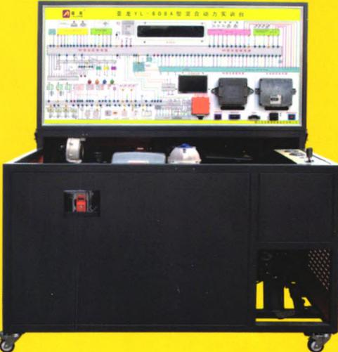
油电混合动力系统维修与调试实训考核装置可使学生了解油电混合动力的基本构造及工作原理，油电混合系统正常运行，有能量回收功能，认识各传感器及执行器的位置及工作原理。通过电脑检测端子，配合万用表和示波器检测。可设置解油电混合动力常见故障，通过故障显示，进行学生故障分析、检测诊断实训，培养学生故障分析检测诊断思维能力。
