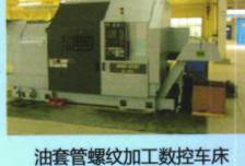
油套管螺纹加工数控车床
