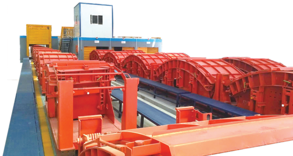
▶ 隧道盾构管片生产线
