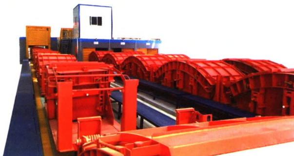
▶ 隧道盾构管片生产线
