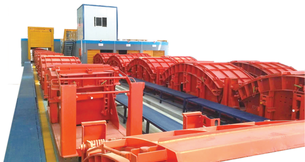
▶ 隧道盾构管片生产线
