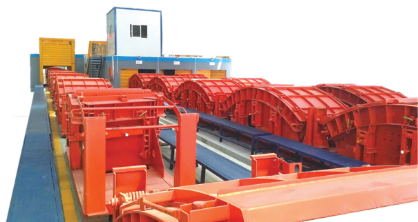
▶ 隧道盾构管片生产线
