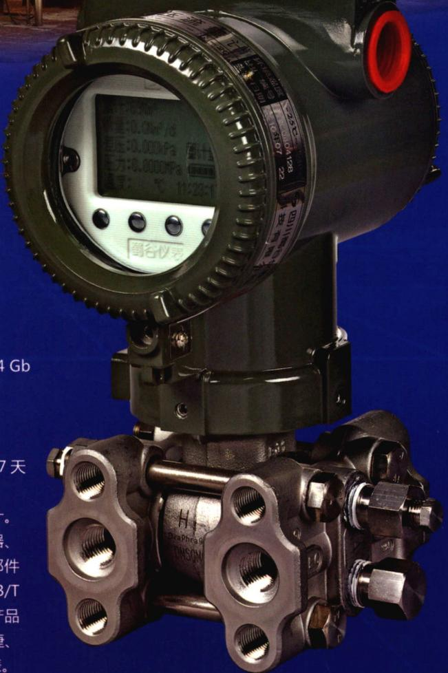
SGQ 智能差压流量计是配合标准孔板节流装置使用的一体化差压式流量计。它以高精度单晶硅谐振式复合传感器为测量元件，在外观结构上与数据采集器、流量积算器、数据储存器、显示器、键盘、电源、信号避雷器、通信接口等部件融为一体，通过自动测量流体的差压、压力、温度并作温压补偿，按国标《GB/T 21446-2008》自动积算天然气流量，并就地显示、储存和上传计量结果。本产品具有计量精度高、性能可靠、单向过载能力强、量程宽、功耗低、校准方式简捷、报表和日志记录完善、安装方便等优点，是天然气输送场合理想的流量计量仪表。
