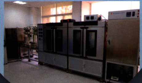
超高压模拟地层条件渗流实验装置
