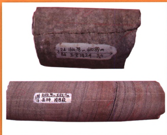
沙溪庙组、须家河组砂岩典型岩心照片
