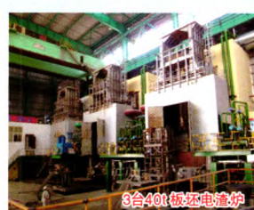
世界最大断面 50吨大型板坯电渣炉
