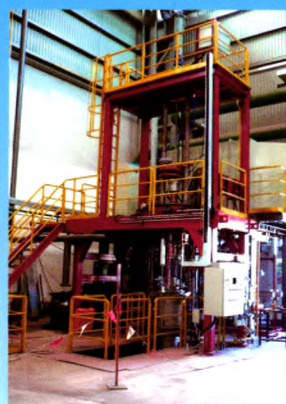
国内首套 自主研发 全密闭保护气氛恒熔速电渣炉
