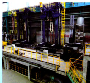
国内首台 世界领先 大型空心管坯电渣炉
