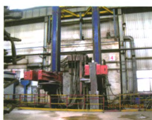
50-300吨 多功能特大型电渣炉
