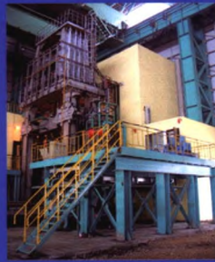
世界最大断面 50吨大型板环电渣炉
