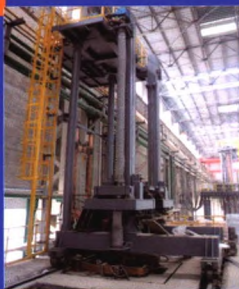
Φ1100×6000mm 半连续抽锭式电渣炉
