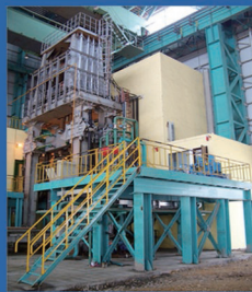
世界最大断面 50吨大型板坯电渣炉
