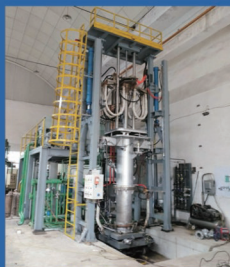
国内首套自主研发 多功能加压电渣炉
