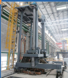
Φ1100×6000mm 半连续抽锭式电渣炉
