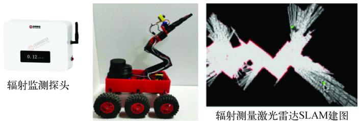
移动辐射监测机器人整体结构
