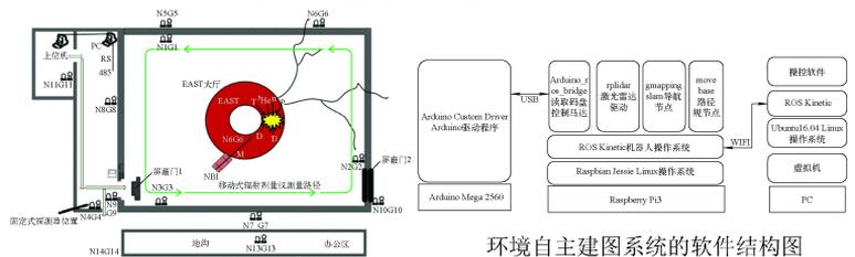
环境自主建图系统的软件结构图
