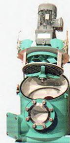
用于切碎介质中的纤维、颗粒、毛发等杂物，确保大块固体被沉降或粉碎，防止管路堵塞、缠绕或损坏后续设备。
