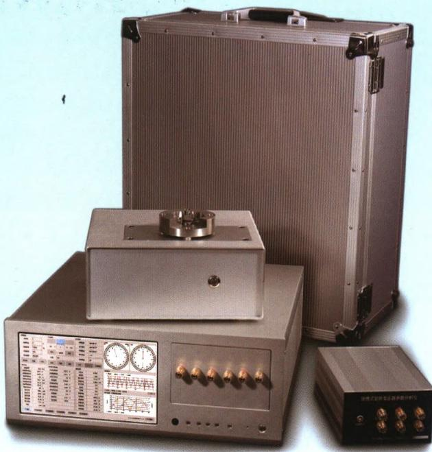
二十多年计量级分析仪器开发经验团队，集当今领先的测量、控制、分析技术之大成，五年磨一剑终成SmartBRX HA Dual双通道旋转变压器高精度测试分析系统。
