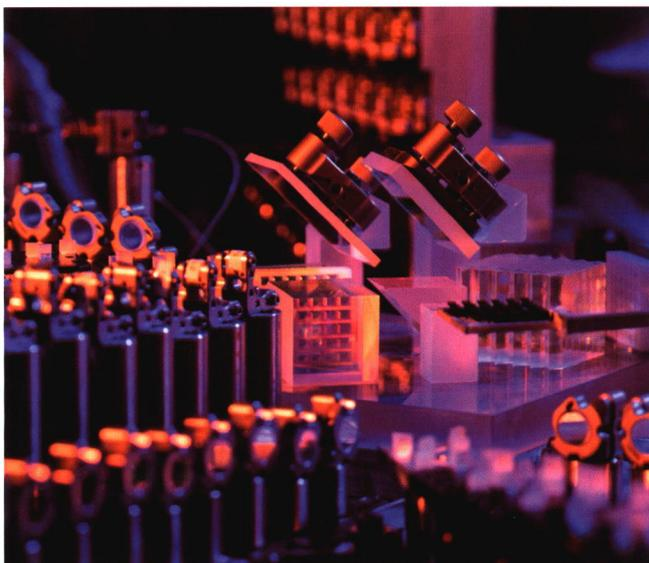
**封面故事** 经典测量方法的精度由于统计涨落与消耗的资源满足 $1/\sqrt{N}$ , 这被称为散粒噪声极限。量子精密测量能够超越这个极限, 逼近或达到海森伯极限 $1/N$ 。理论上, 可以通过制备特定的多光子纠缠态, 例如 $N00N$ 态, 达到这个精度。但是高光子数的 $N00N$ 态制备非常困难, 且无法容忍光子的损耗噪声。在“九章”量子计算原型机的研制过程中, 中国科学技术大学的潘建伟和陆朝阳研究团队发展了基于量子干涉的高效率受激压缩光源, 这种光源是一种 $SU(1, 1)$ 非线性干涉仪。他们在未扣除任何实验噪声的情况下, 实现了对相位的鲁棒量子精密测量优越性, 首次观测到平均每个光子获得的信息量超越散粒噪声极限达到5.8(1)倍, 优于理想的5光子 $N00N$ 态, 这为低光子通量条件下的实用精密测量开辟了一条新的途径。该工作发表于 *Phys. Rev. Lett.*, 2023, 130: 070801。
