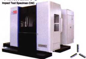
冲击试样加工中心
