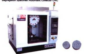
多功能低倍铣磨、腐蚀自动化系统
