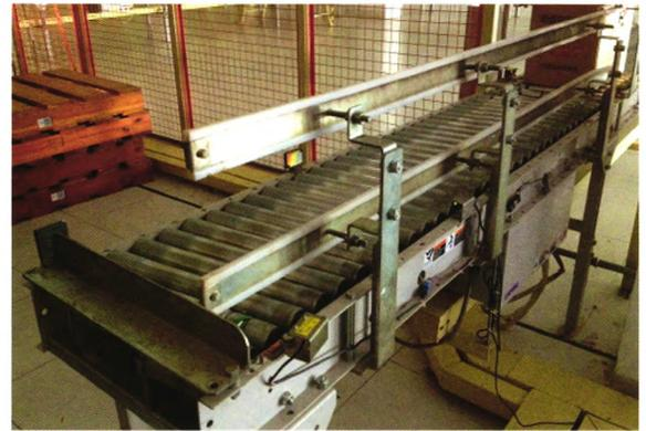
部位开裂现象。改进后使用效果良好，实现更稳定的码垛，降低了设备故障率，同时提高了设备运行效率和使用寿命，确保码垛系统正常运行。
