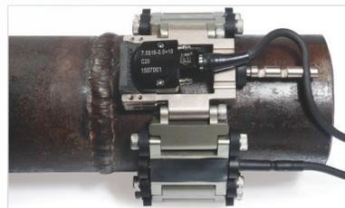
小径管焊缝检测
