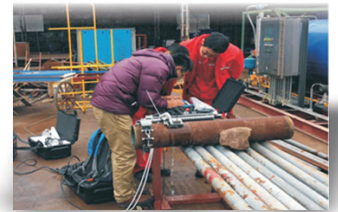
管道腐蚀二维 C 扫检测
