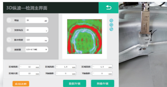
汽车点焊实时3D全聚焦检测（俯视）
