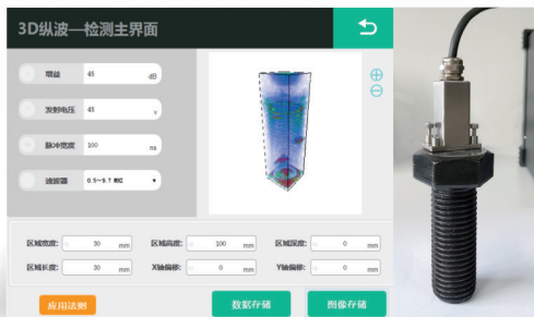
螺栓的实时3D全聚焦检测
