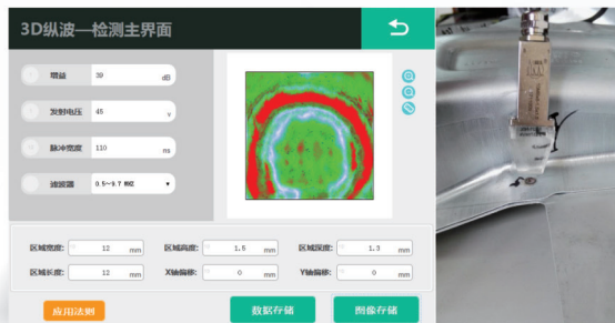
汽车点焊实时3D全聚焦检测 (俯视)
