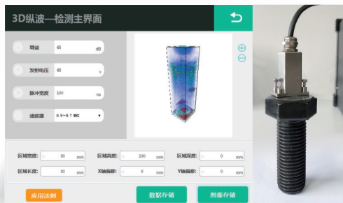
螺栓的实时3D全聚焦检测
