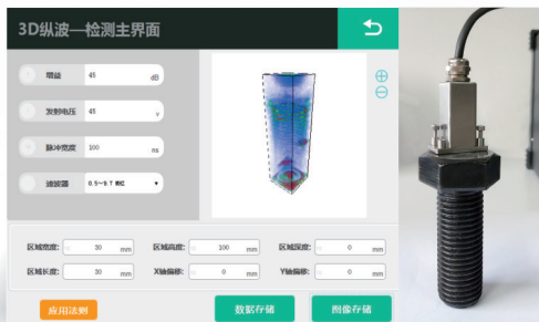
螺栓的实时3D全聚焦检测
