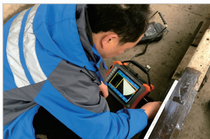
钢轨焊缝检测
