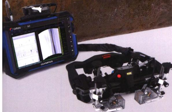
**omniscan X3 + AxSEAM纵/环焊缝扫查器**
