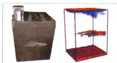
锻件实时3D全聚焦成像检测
