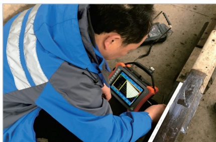
钢轨焊缝检测
