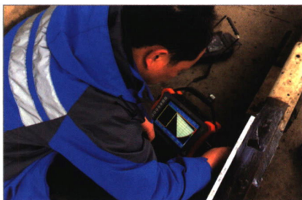
钢轨焊缝检测
